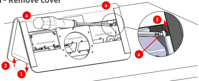
**1 Abdeckung abnehmen:** Tischanschlussfeld wie gezeigt ablegen, zwei Klemmschrauben **a** ca. 5 mm lösen, bis die Abdeckung abgenommen werden kann.
