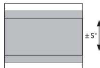
Mit der Rändelschraube **C** setzen Sie die obere Bildkante in Waage.
