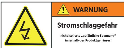
⚠️ **Hinweis:** Bei den mit dem Symbol "⚡" gekennzeichneten Anschlüssen kann Stromschlaggefahr bestehen! Die externe Verdrahtung, die an die Klemmen angeschlossen wird, muss von qualifiziertem Personal oder mit vorkonfektionierten Kabeln installiert werden.
