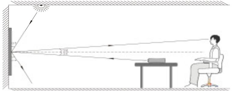
**Note:** Falsche Installation führt zu Lichtverlust und einem dunklen BILD!!
