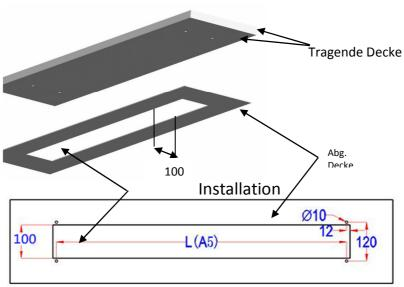
2. Bohren Sie 4 Installationslöcher in die tragende Decke (korrespondierend zu dem Leinwandgehäuse)
