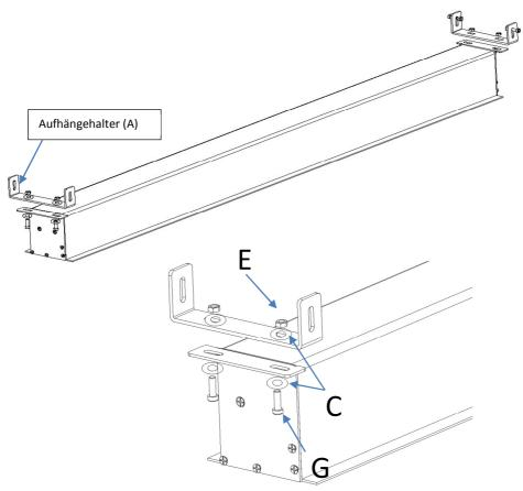
2. Die Halterstangen (B) über die Aufhängehalter (A) legen und verschrauben(mit M6x20mm Schrauben (B), M6x13mmx2mm Scheiben (E) und den M6 Nut (F). Muttern.
