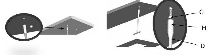
5. Jetzt die Schraubstangen (C) in den Dübel Bolzen befestigen. Dann die Muttern (F.) und Unterlegscheiben(E) wie im Schaubild befestigen. Als letztes den Aufhängehalter (B)entsprechend der Höhe befestigen
