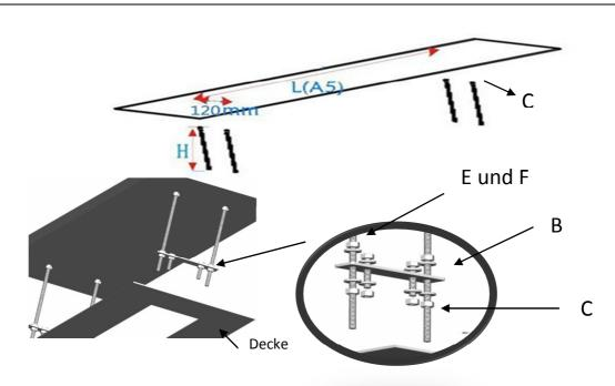
5. Befestigen Sie die Leinwand an den Schraubstangen (C). The **Scheiben** (E) zusammen mit den Muttern (F) halten die Leinwand an der Haltevorrichtung.
