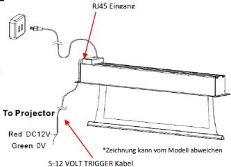
**2. 3-Wandschalter:** wird direkt an die RJ45 Schnittstelle angeschlossen.
