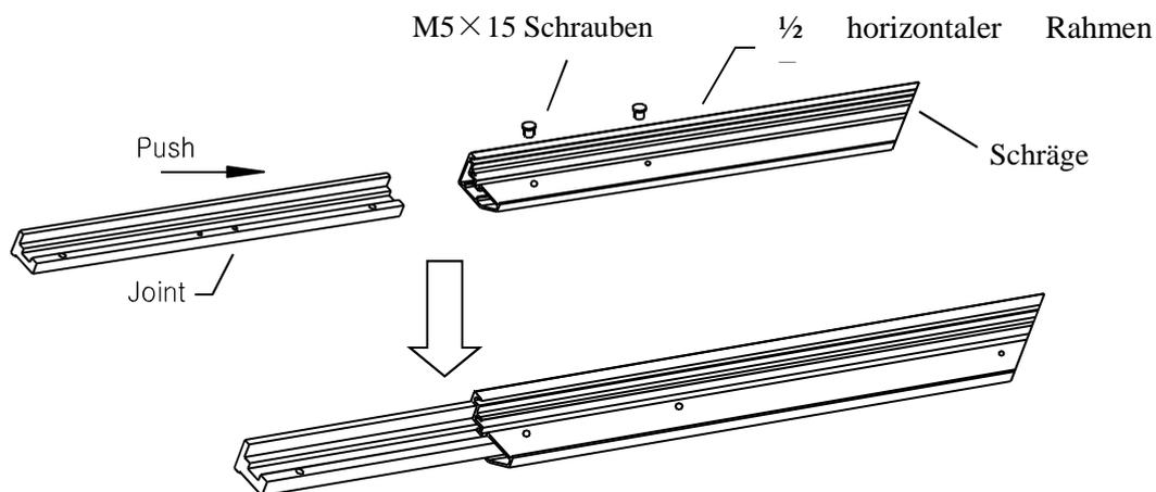
2. Die andere Hälfte des horizontalen Rahmens mit dem Verbindungsstück Mitte verbinden und mit 2 **M5x15 verschrauben**.. Wiederholen Sie diese Schritte für den 2ten horizontalen Rahmen..
